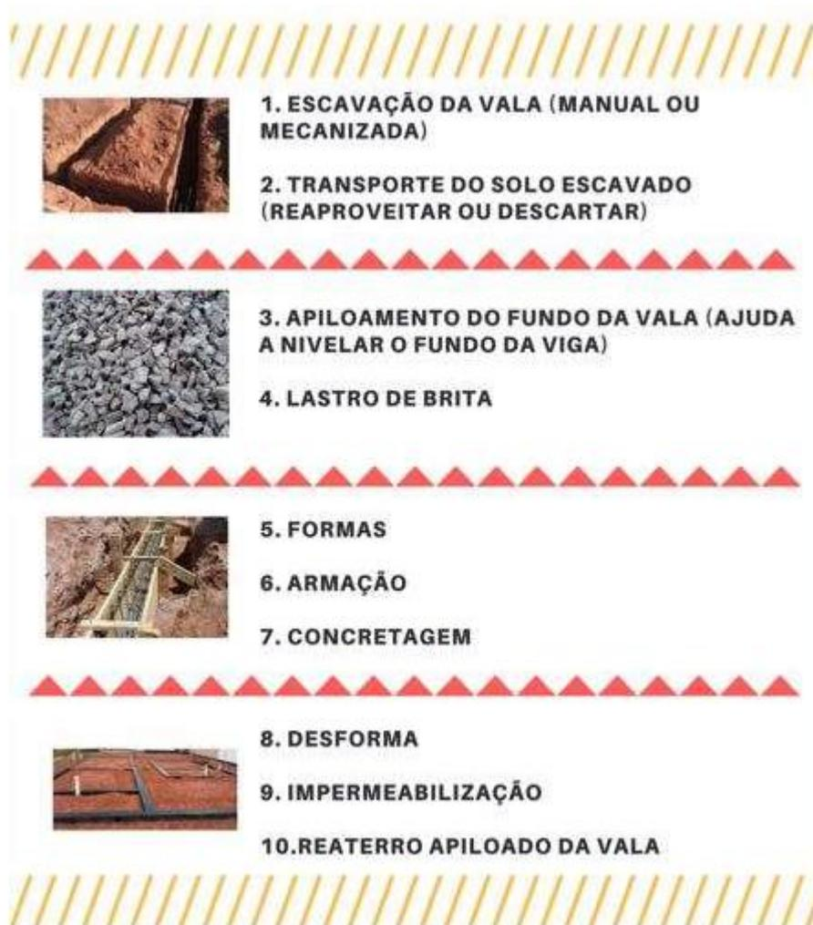
Figura 62 - Escopo de Viga Baldrame
