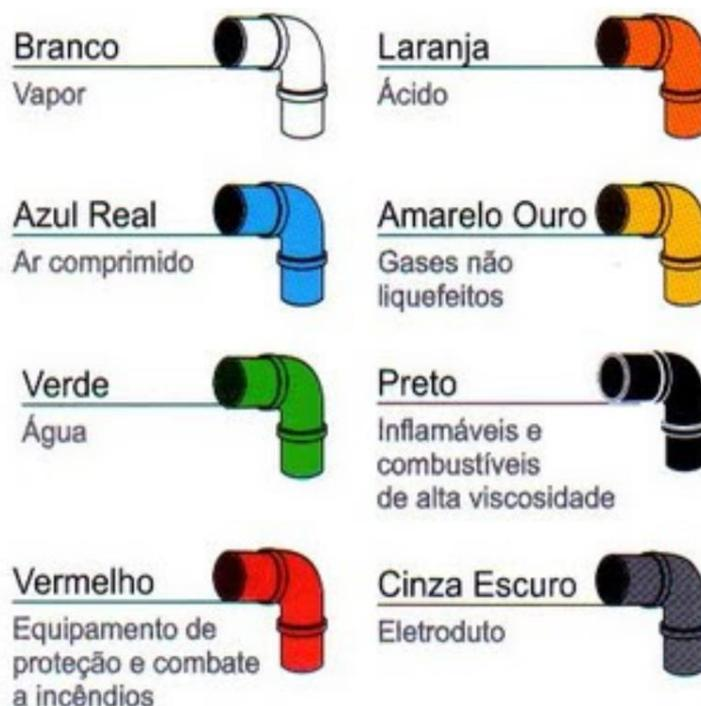
Figura 68 - Cores das Tubulações - NBR 6493 (Representação genérica)
